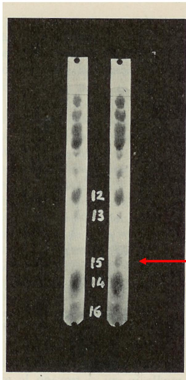
Fig. 1. - Cromatogramma bidimensionale degli aminoacidi costituenti l'Hb umana fetale cristallizzata. Da destra a sinistra, fenolo; dal basso in alto collidina-lutidina. La soluzione posta nell'angolo a destra in basso era ossidata con  $H_2O_2$  e molidato d'ammonio per evidenziare la cistina e la metionina. Aminoacidi numerati come dal testo (pagina 89).
