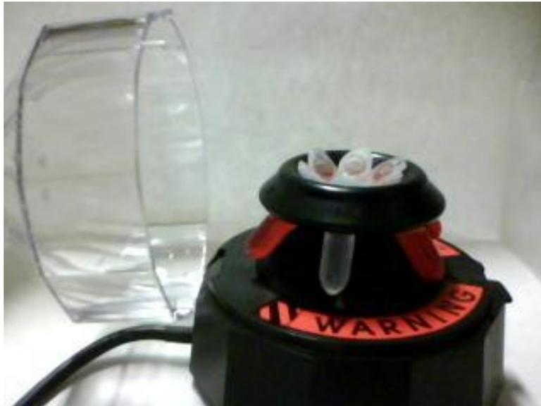
Dopo 2 min. di centrifugazione a 5000 giri /min. la centrifuga viene fermata e si estraggono le provette.
